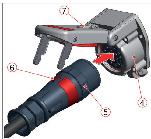
Abb. 21: Pfeil (6) auf Stecker deckungsgleich zu Pfeil (7) auf Dosendeckel ausrichten
